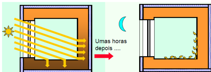
Figura 3.33: Efeito do isolamento pelo exterior na inércia térmica [Gomes & Silva, 2015]
